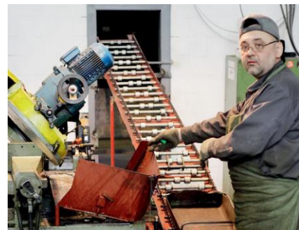
Устройство транспортировки заготовок с заготовительного участка в кладовую механического участка ПАО «ЗиО-Подольск»
