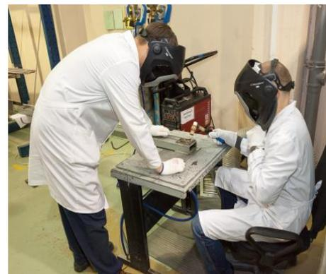
*Рабочий процесс до улучшения: сборка и прихватка выполняется слесарем и сварщиком*
