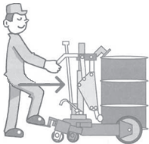
Для начала движения тележки с устройством достаточно усилия в 7 кг
