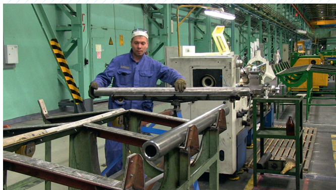
Станиславу Блинову , токарю 6 разряда цеха № 85 теперь не нужно вручную переносить заготовку весом более 50 кг
