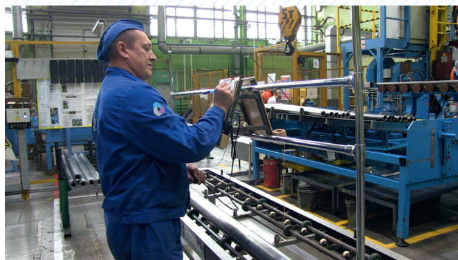
С появлением мобильного стола на участкековки замеры труб выполняет 1 сотрудник
